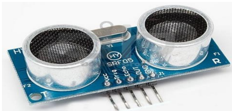
Hình 2.5. Ảnh thực của cảm biến siêu âm SRF05
