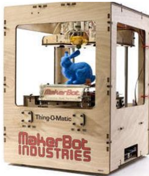
Hình 2.7. Máy in 3D Makerbot điều khiển bằng Arduino Mega2560
