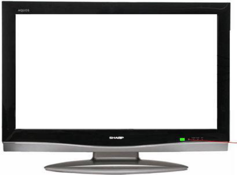
Hình 3.6.1 – Khi mất điện áp Vcc 5V cấp cho mạch LVDS trên màn hình, màn hình chỉ có màn sáng trắng, không có hình..
