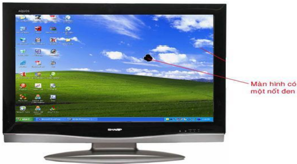
Hình 3.4.1 – Màn hình có vết đen trên màn hình
