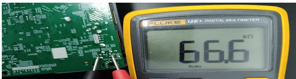
Hình 3.7.2 – Dùng đồng hồ đo kiểm tra trở kháng chân loa
