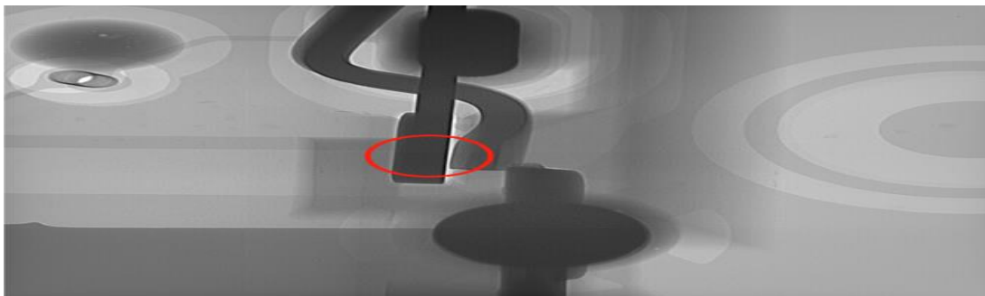
Hình 3.7.3– Dùng máy Xray kiểm tra chân bên trong
