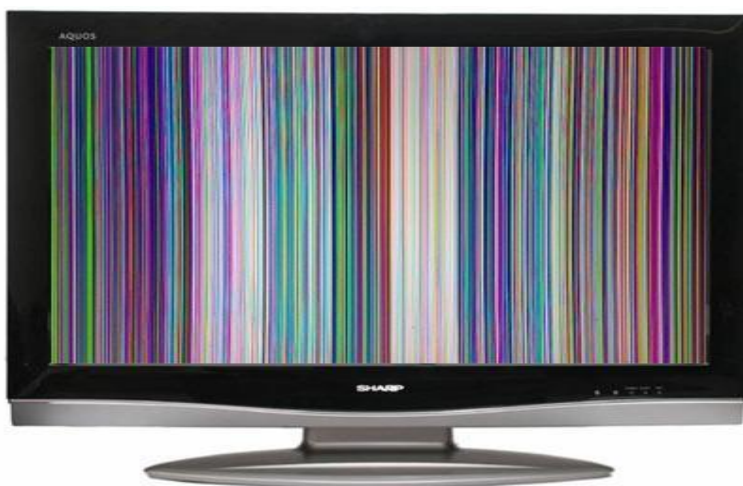
Hình 3.5.1 – Khi bị mất điện áp điều khiển Pixel Clock - Màn hình có các sọc màu xanh đỏ dọc màn hình, không có hình.
