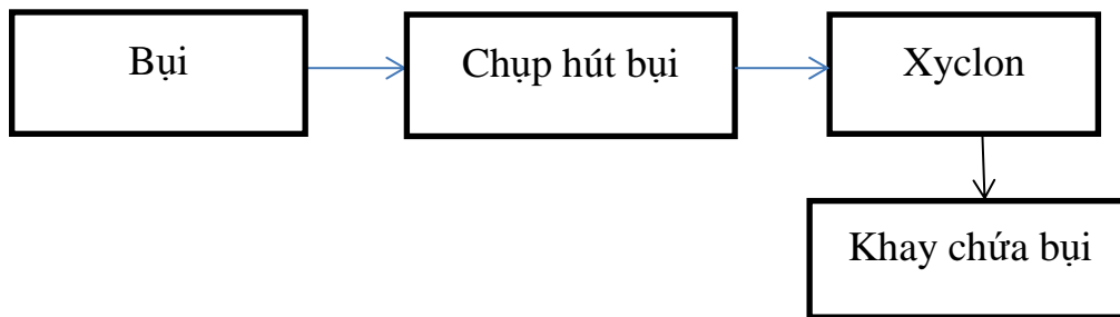
Hình 3.1. Sơ đồ quy trình xử lý bụi cho máy mài biên
