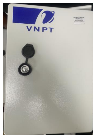
Hình 3-15: Hình ảnh thực tế hộp Splitter cấp 2 loại 1:16
