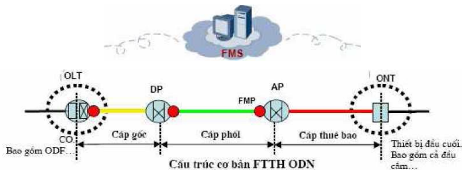
Hình 2-5: Cấu trúc cơ bản mạng cáp quang thuê bao
