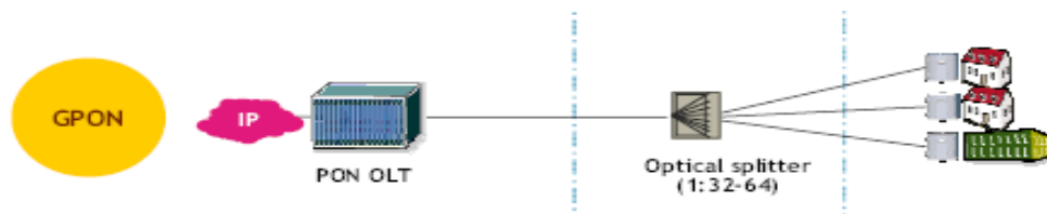
Hình 3-3: Công nghệ truy nhập quang thụ động
