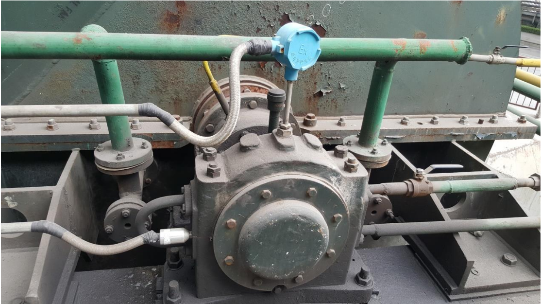
Hình 32: Cảm biến đo độ rung và nhiệt độ gói quạt
