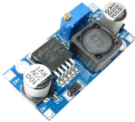
Hình 1. 6. Bo mạch sử dụng IC LM2569
