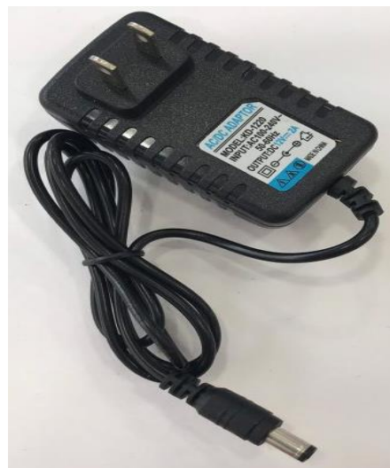
Hình 1. 5. Mạch chuyển nguồn từ AC~220V sang DC-12V
