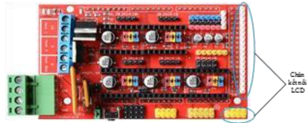
Hình 4.59: Vị trí kết nối LCD
