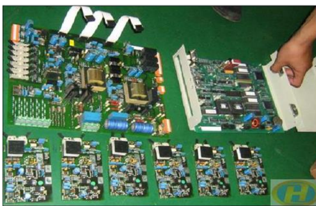
Hình 1.5.1b: Các board mạch điều khiển và bảo vệ IGBT
