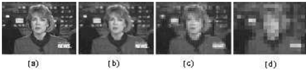
Hình 1-2: (a) Ảnh ban đầu có độ phân giải n = 1 ; (b), (c), và (d) Ảnh có độ phân giải n = 4, 8, 16 .
