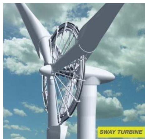
Hình 3.5. Hình ảnh của máy phát điện DD đường kính lớn của Sway Turbine.
