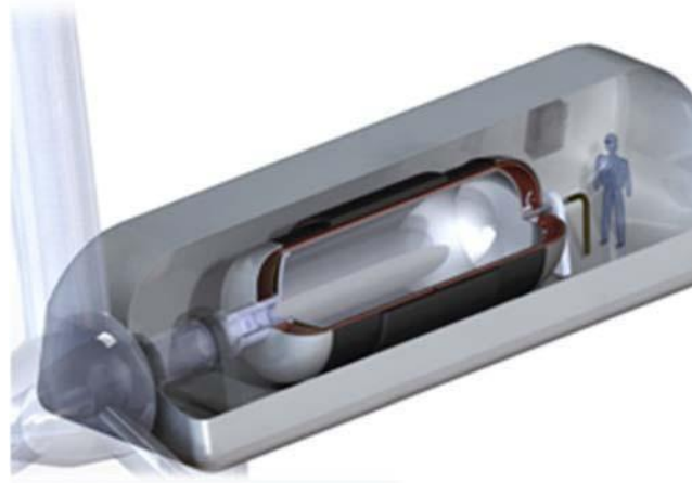
Hình 3.13. Máy phát điện tuabin gió MgB 2 10 MW được đề xuất từ AML. Sao chép từ [81].
