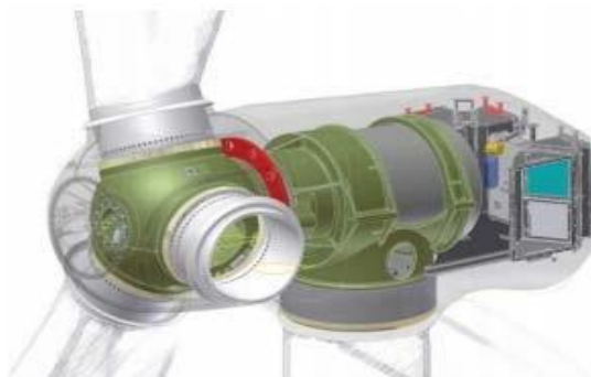
Hình 3.11. Máy phát điện tuabin gió LTS 10 MW được đề xuất từ GE. Sao
