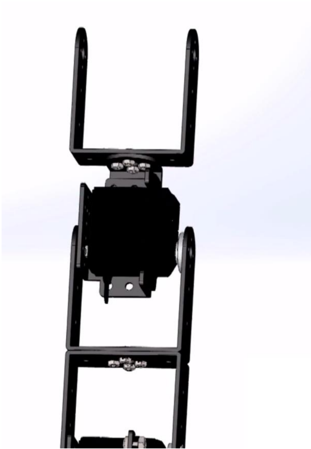
Hình 3.29. Lắp ráp cánh tay cùng động cơ
