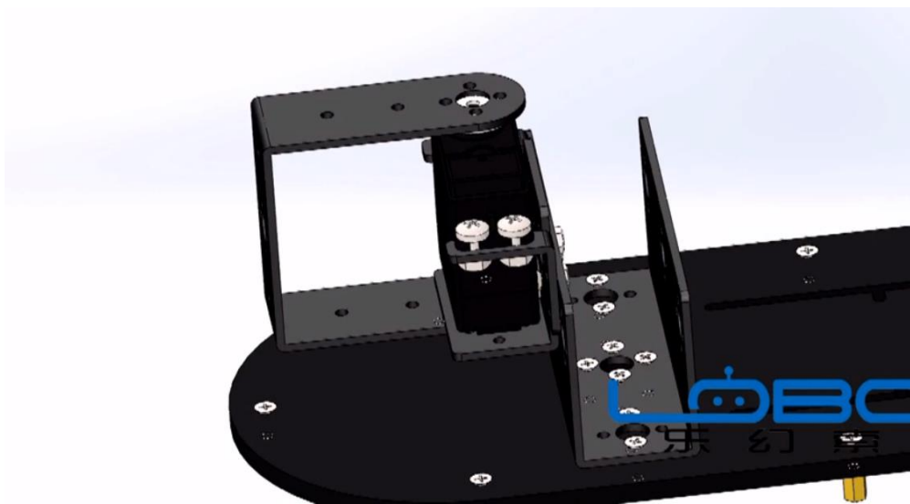
Hình 3.24. Lắp động cơ
