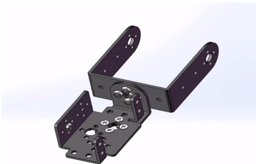
Hình 3.27. Tiếp tục lắp cánh tay và động cơ vào để quay
