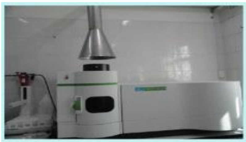
Hình1.4: Máy phân tích quang phổ phát xạ ICP-OES
