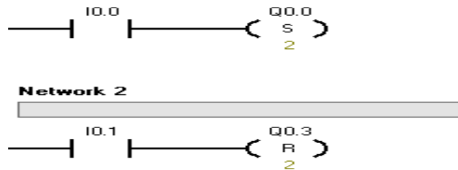
Hình 3.8 Mô tả lệnh Set và Reset
