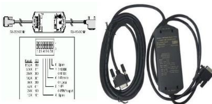
Hình 2.5 Cáp PC/PPI kết nối RS232 với RS485
