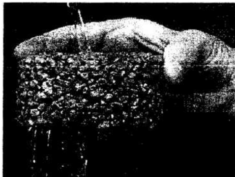
Hình 1.1. Độ rỗng của vật liệu là một trong những nguyên nhân gây ra thấm
