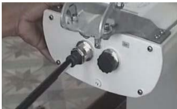
Hình 3.5. Đầu nối dây nhảy vào anten
