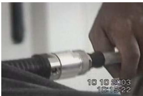
Hình 3.6. Nối phích vào dây nhảy
