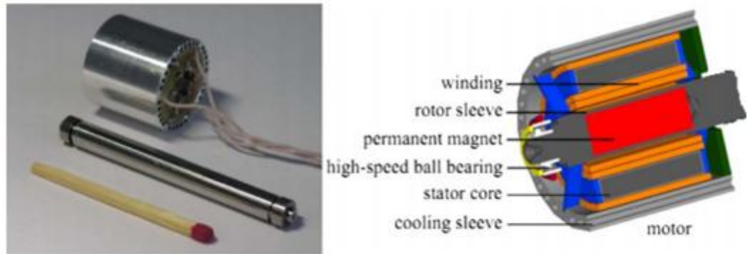
Hình 1.19. Máy điện 100-W 500 000 vòng/phút
