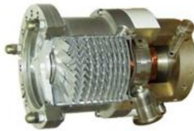
Hình 1.6. Máy bơm kiểu tuabin truyền động bởi một động cơ tốc độ cao
