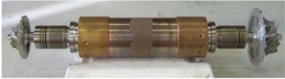
Hình 1.16. Rotor lồng sóc 300 kw 60000vòng/phút
