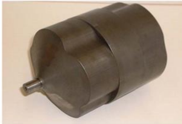
Hình 1.20. Máy điện 30 kW ,100 000-r/min ,140 Wh cho bánh đà tích hợp
