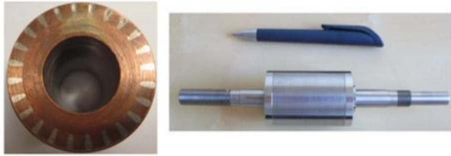
Hình 1.17. Rotor lá thép mỏng 10kW 80000 vòng/ phút
