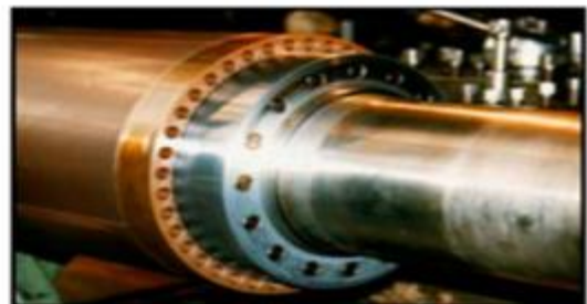
Hình 1.8. Máy điện cảm ứng (máy điện ko đồng bộ) 10 MW 20000-vòng/phút
