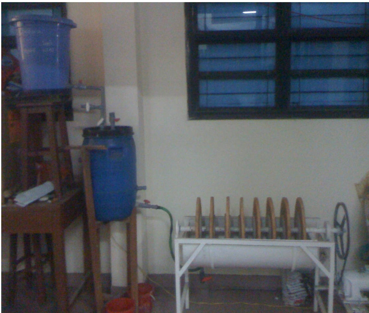
Hình 2.5. Mô hình xử lý nước thải bằng lọc kỵ khí kết hợp đĩa quay sinh học quy mô phòng thí nghiệm
