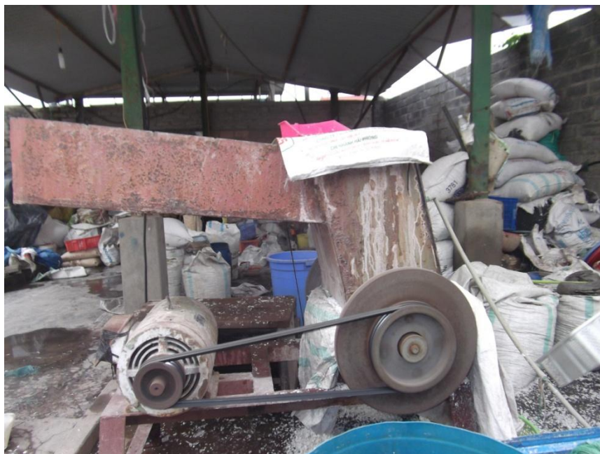
Hình 3.13: Máy xay nhựa điển hình tại phường Tràng Minh
