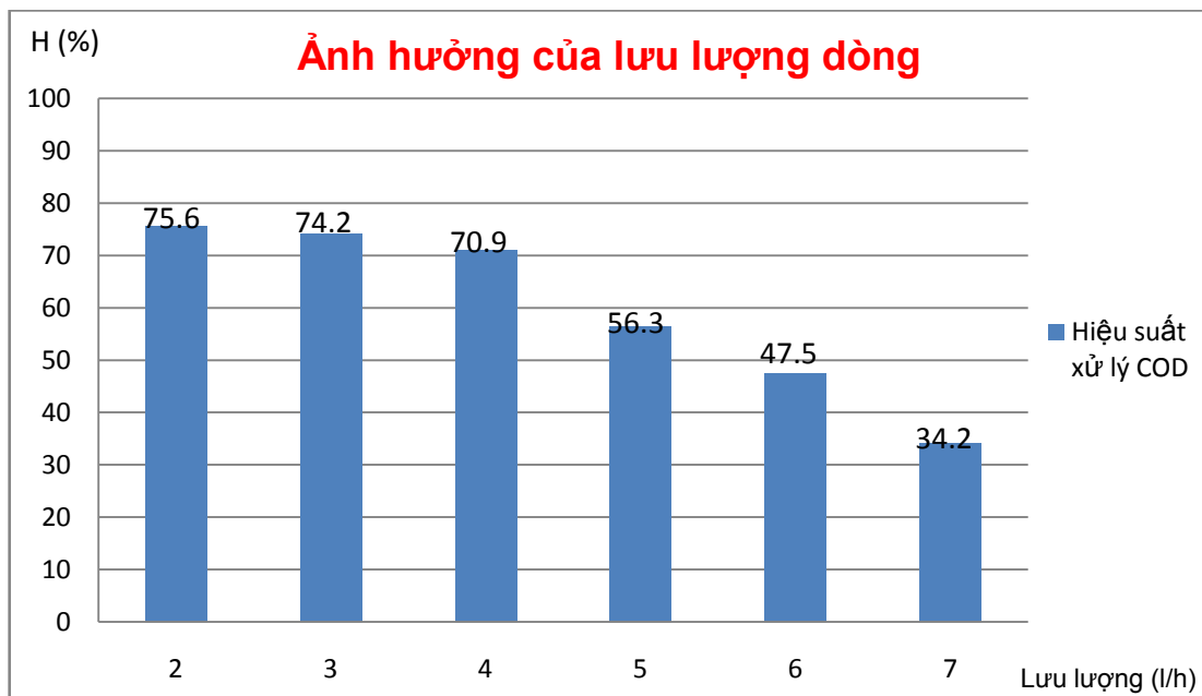
Hình 3.1: Ảnh hưởng của lưu lượng dòng tới hiệu quả xử lý COD
