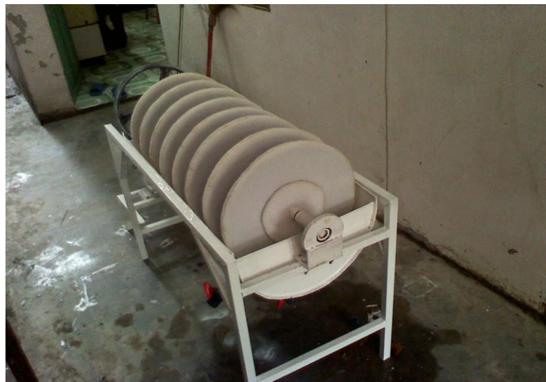
Hình 2.3. Mô hình RBC được tính toán và lắp đặt
