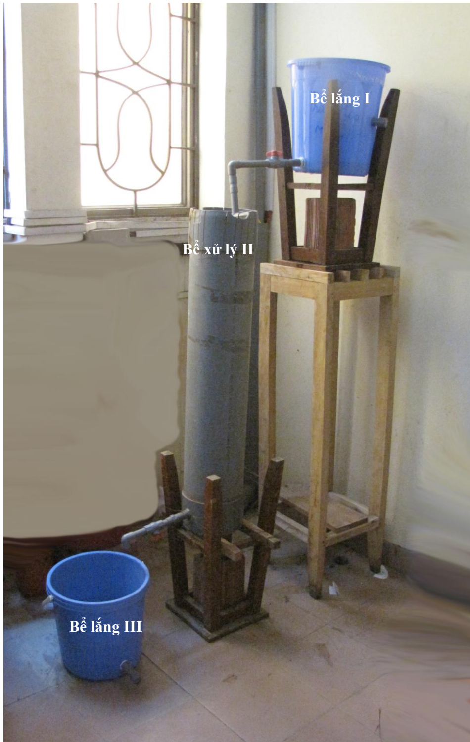
Hình 2.3. Hệ thống mô hình thí nghiệm
