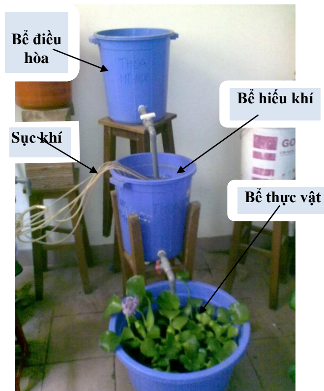
Hình 2.5. Hệ thống xử lý nước thải chợ bằng phương pháp lọc sinh học hiếu khí quy mô phòng thí nghiệm
