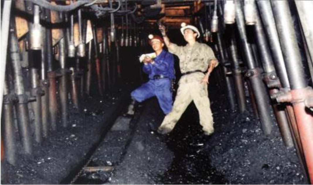
Hình 1.1: Kiểm tra cột chống thủy lực độ sâu -250m dưới lòng giếng đứng Mông Dương.
