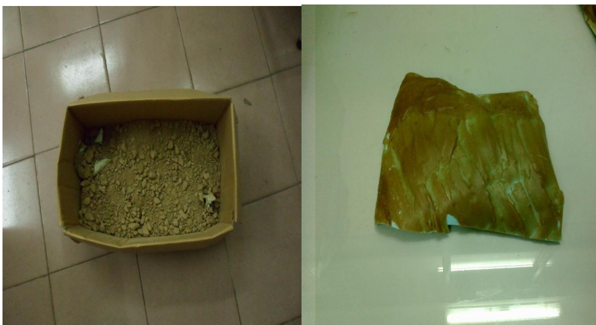
Hình 3.6. Theo dõi sự phân hủy sinh học của nhựa trong môi trường đất
