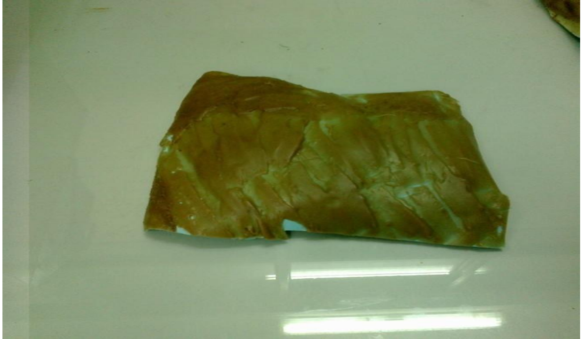
Hình 3.3. Theo dõi sự phân hủy sinh học của nhựa trong điều kiện không khí khô
