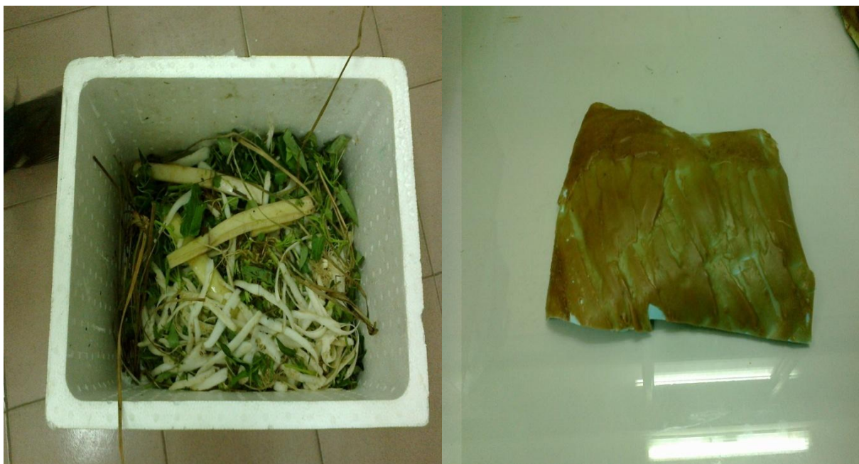
Hình 3.5. Theo dõi sự phân hủy sinh học của nhựa trong môi trường Rác thải ở điều kiện hiếu khí
