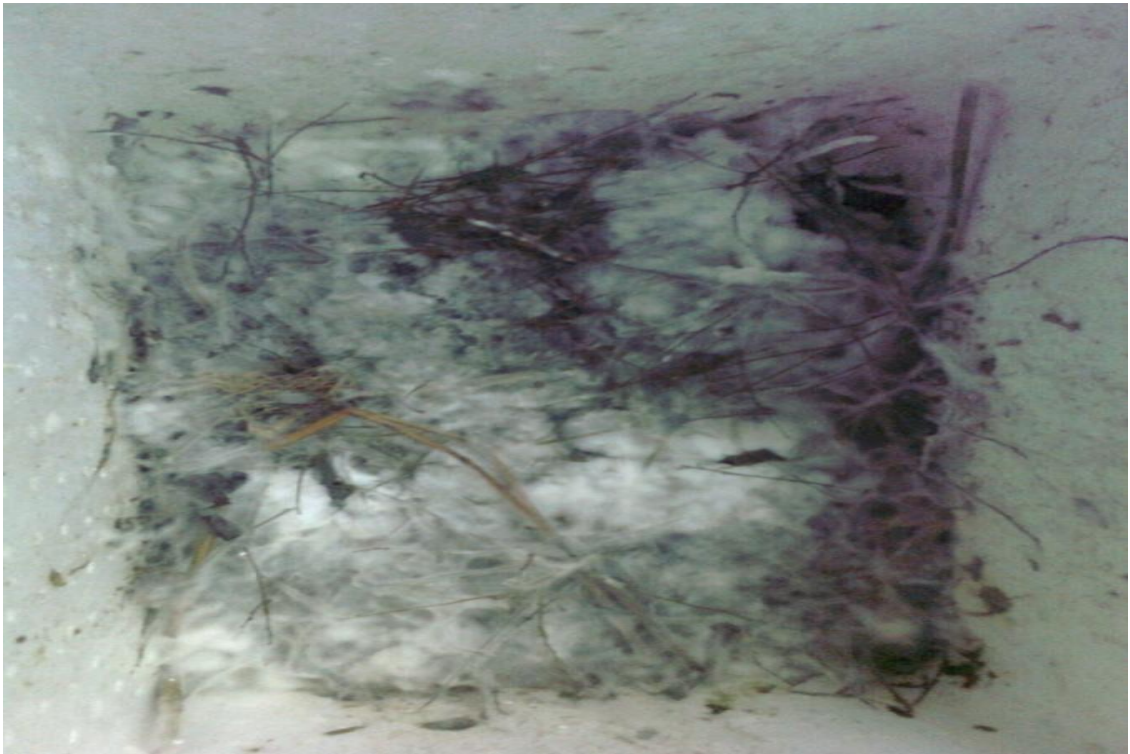
Hình 3.10. Sự phân hủy sinh học của nhựa trong môi trường rác thải ở điều kiện kỵ khí có bổ sung chế phẩm EM sau thời gian 30 ngày
