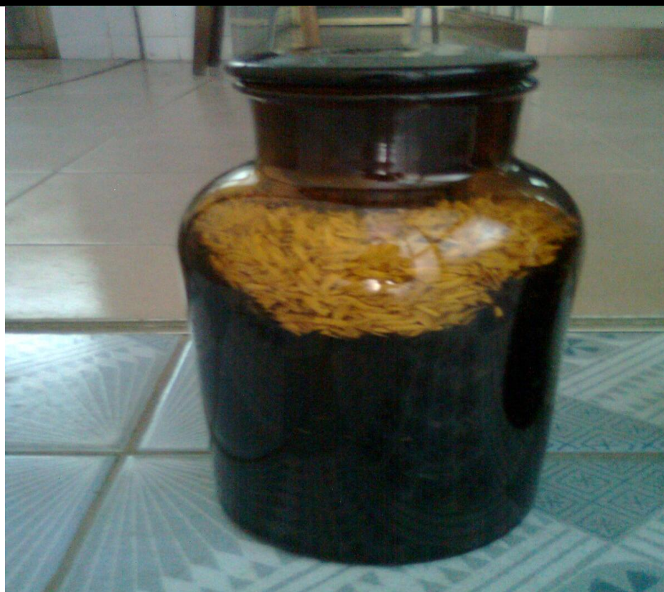
Hình 2.2. Vỏ trấu được than hóa bằng H_2SO_4 98%
