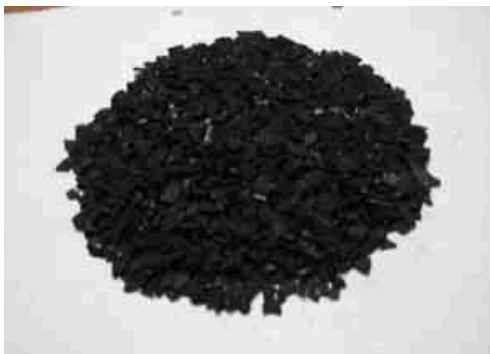
Hình 2.2. Vỏ trấu được than hóa bằng H_2SO_4 98%
