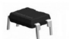
Hình 3.9: Sơ đồ chân và cấu tạo của PC817
