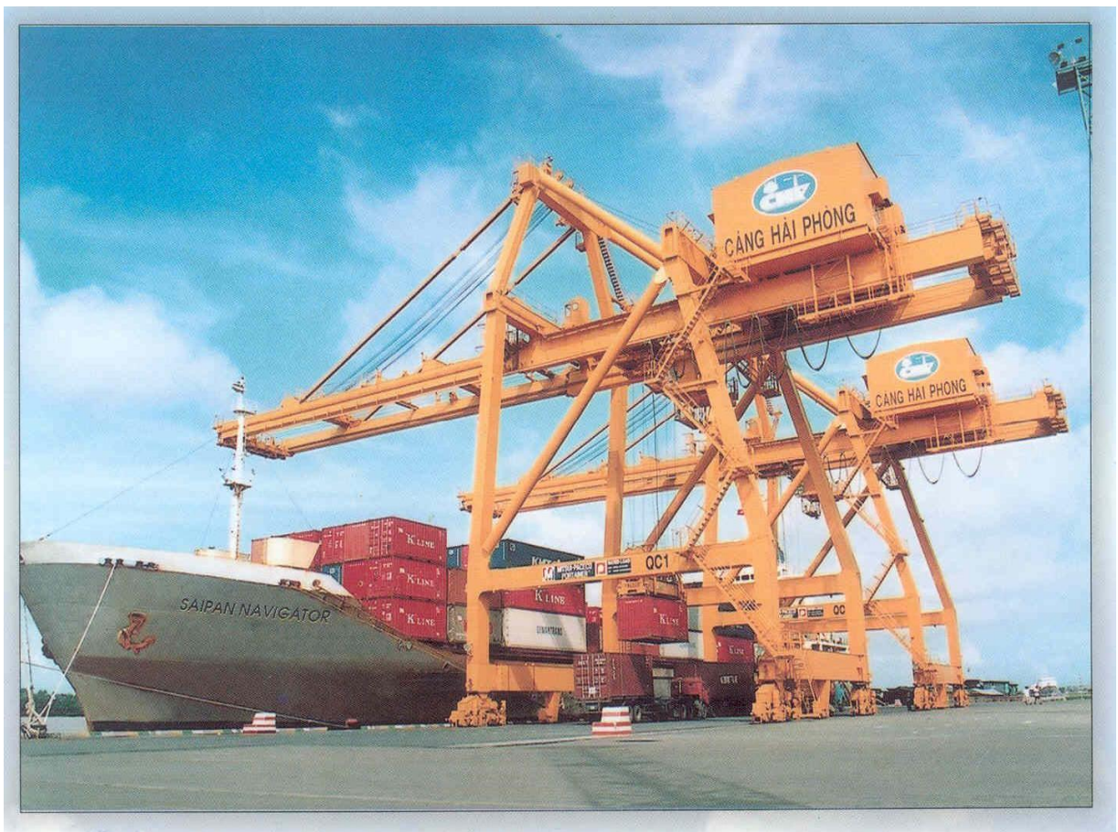
Hình 1.1: Cầu trục giàn bốc xếp container cho tàu biển
