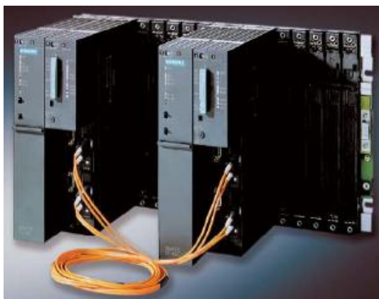
Hình 1.4: Trạm điều khiển trung tâm S7-400H
