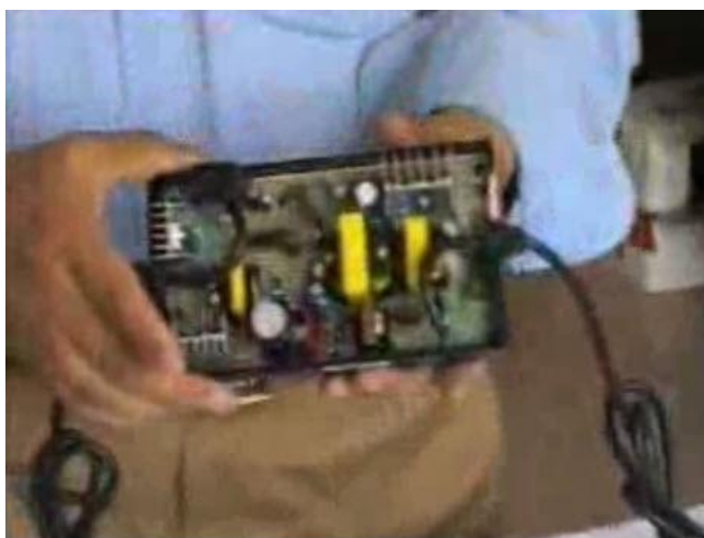
Hình 3.4: Hình bản mạch trong hộp nạp ác quy.
