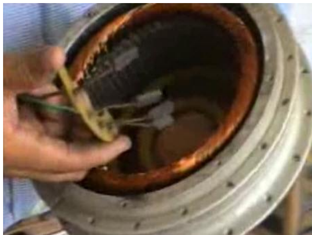
Hình 3.1: Hình chụp chổi than của động cơ.
