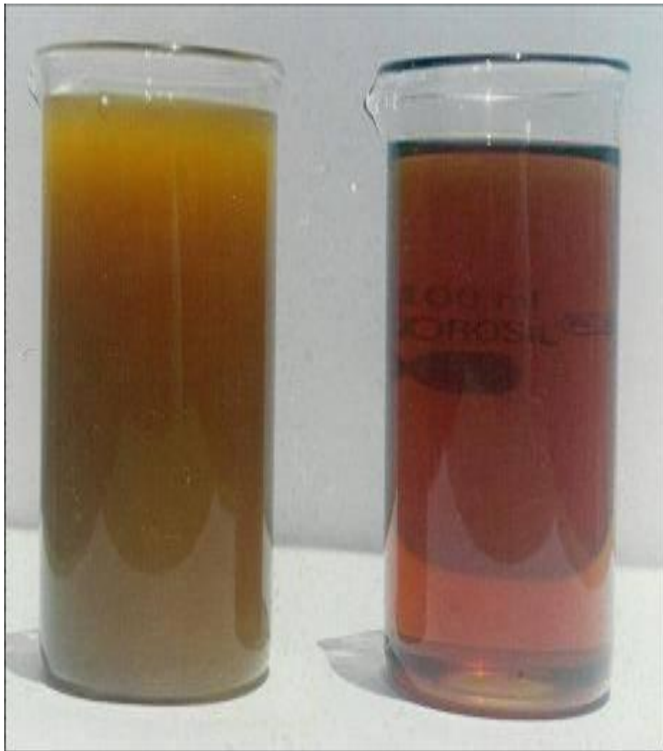
Hình 1.4 : Mẫu dầu trước và sau khi lọc.
