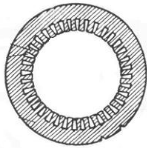
Hình 1.29. Kết cấu stator động cơ không đồng bộ
