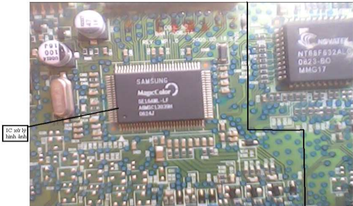
Hình 3.17 : Mạch xử lý hình ảnh thực thể màn hình LCD SAMSUNG 740N
