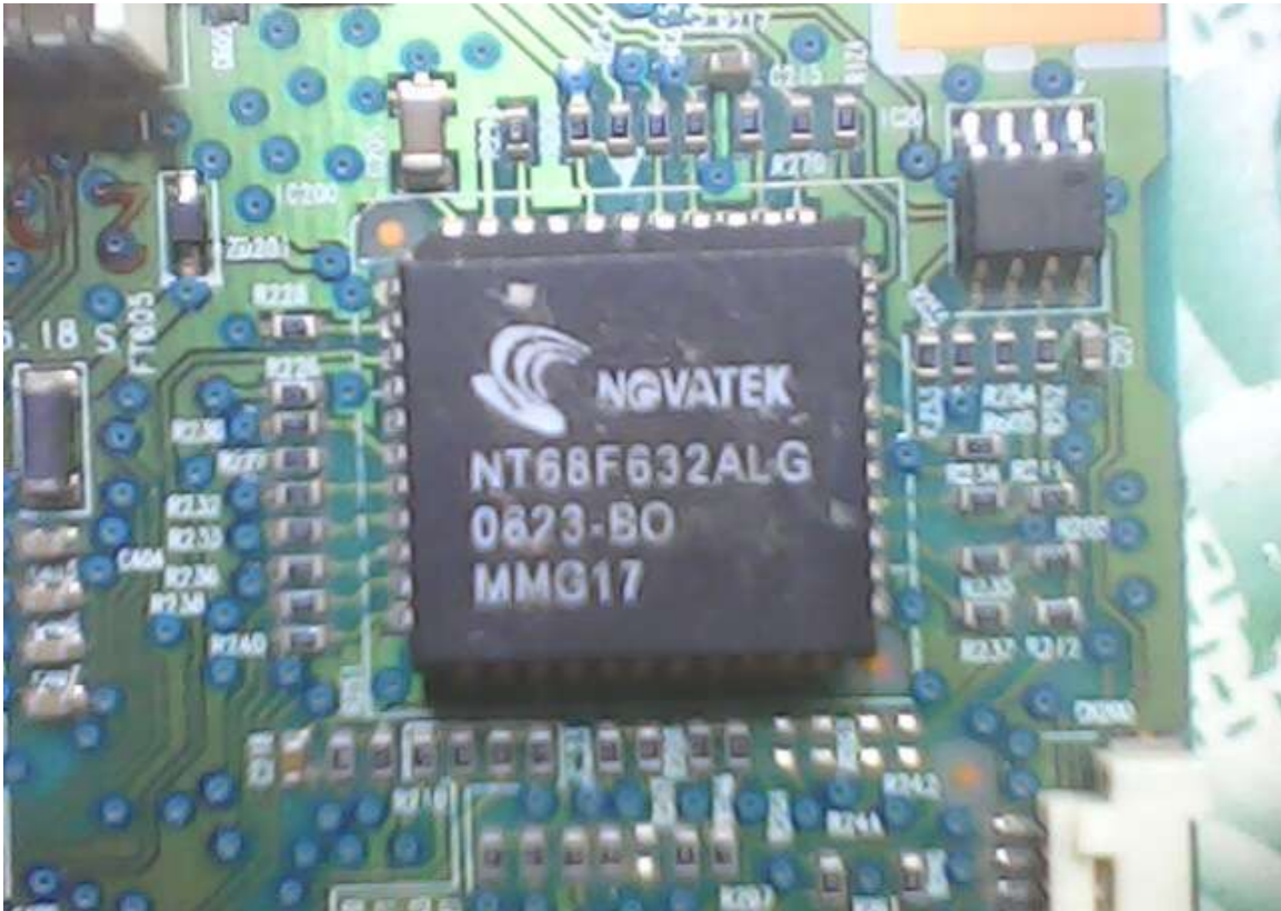
Hình 3.7 : Mạch vi xử lý thực tế màn hình LCD SAMSUNG 740N
