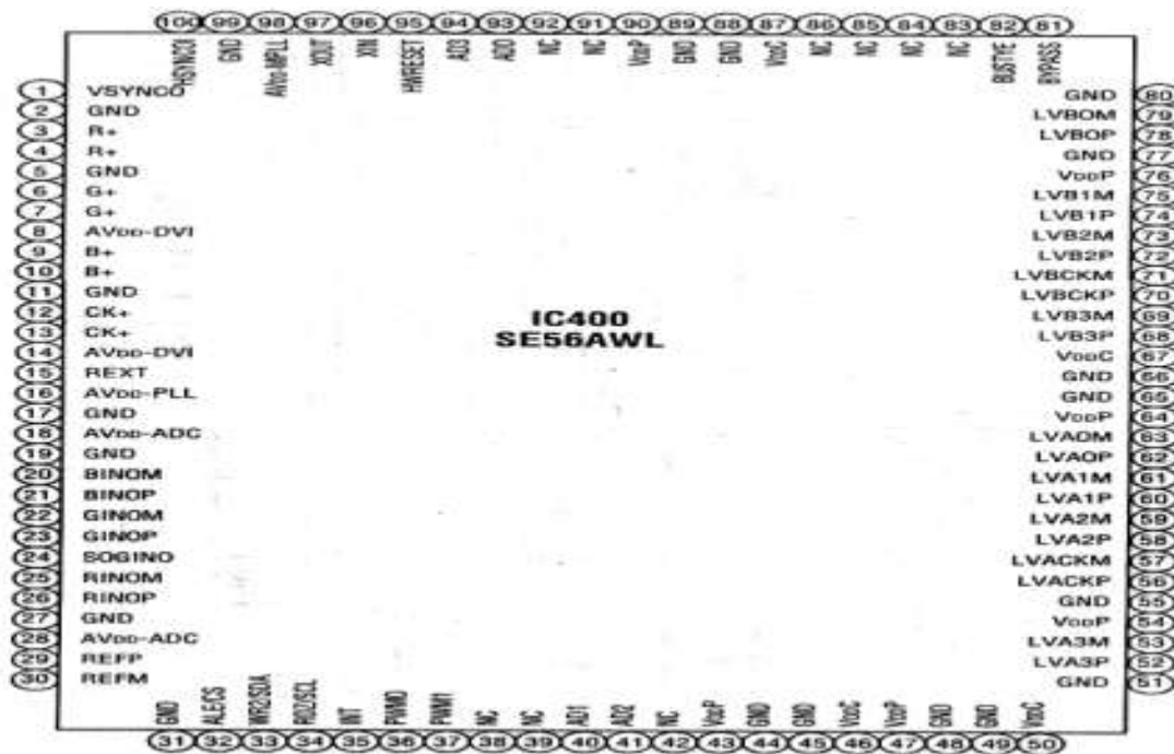
Hình 3.18 : Sơ đồ chân IC SE56AWL
