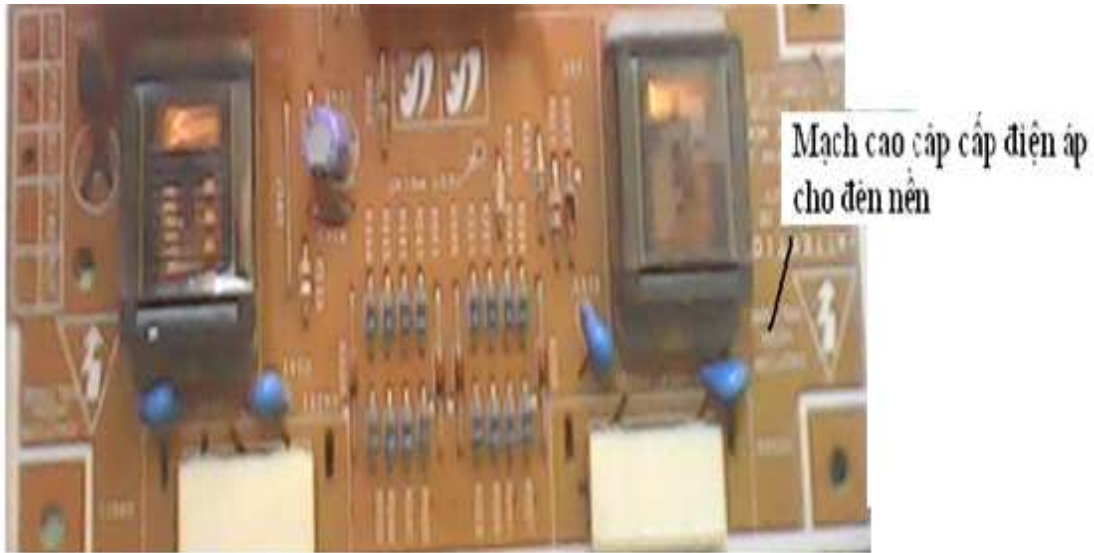
Hình 3.5 : Mạch cao áp thực tế của màn LCD SAMSUNG 740N
