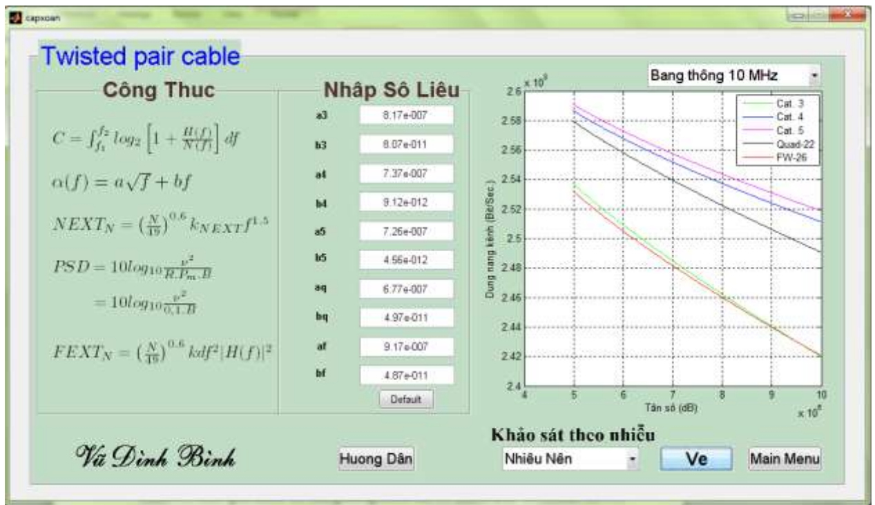
Hình 4.5. Kết quả khảo sát dung năng kênh khi có nhiễu nền -140dBm/Hz với băng thông 10MHz
