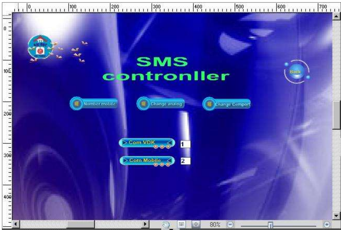
Hình 3.13. Setting lựa chọn cổng com cho vi điều khiển và điện thoại
