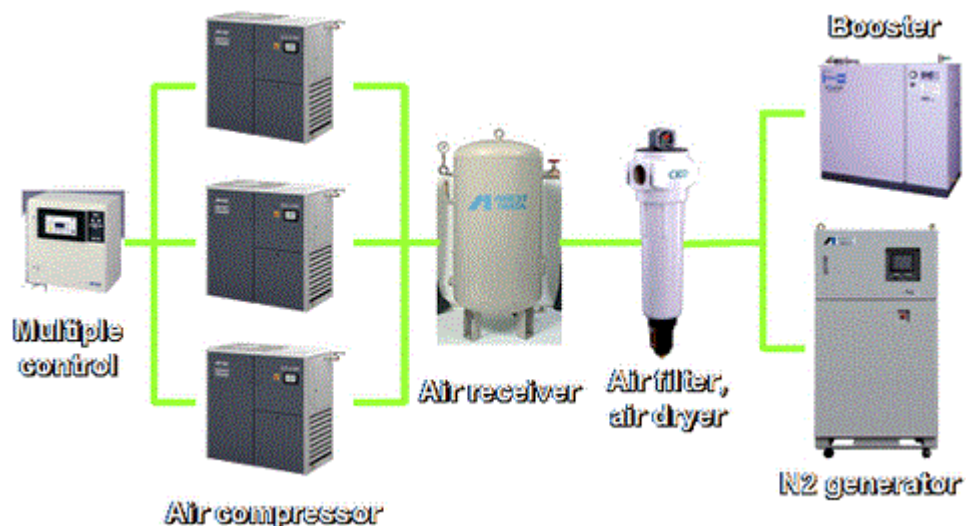
Hình 1.9. Hệ thống máy nén khí nhãn hiệu ANEST IWATA
