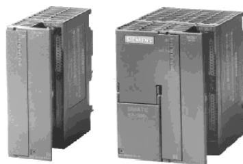
Hình 1.15: Miêu tả hình dáng module IM361.
