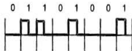
RZ: 1 ứng với mức tín hiệu cao trong nửa chu kỳ bit T, 0 với mức thấp trong suốt chu kỳ bit
