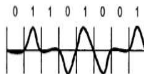
AFP: Thay đổi giữa 0 và 1 được đánh dấu bằng một xung xoay chiều
