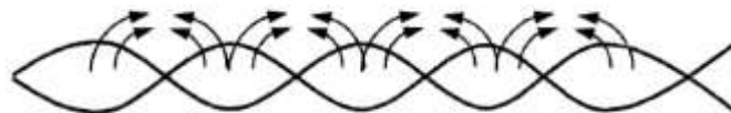
H 1.32 Đôi dây xoắn và tác dụng trung hoà trường điện từ.
