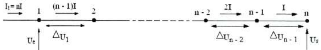
Hình 1.7. Điện áp rơi trên đường trục.
