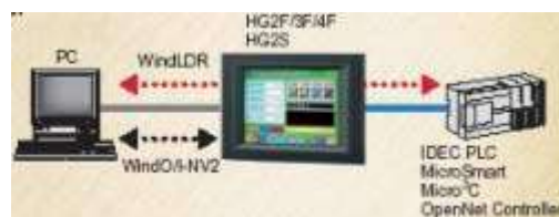
Hình 1.18: Sơ đồ chức năng thay đổi dữ liệu của PLC thông qua HMI
