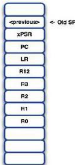
Hình 1.15. Stack frame trong chế độ ngắt
