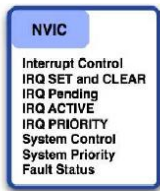
Hình 1.21. Các thanh ghi trạng thái và điều khiển của NVIC
