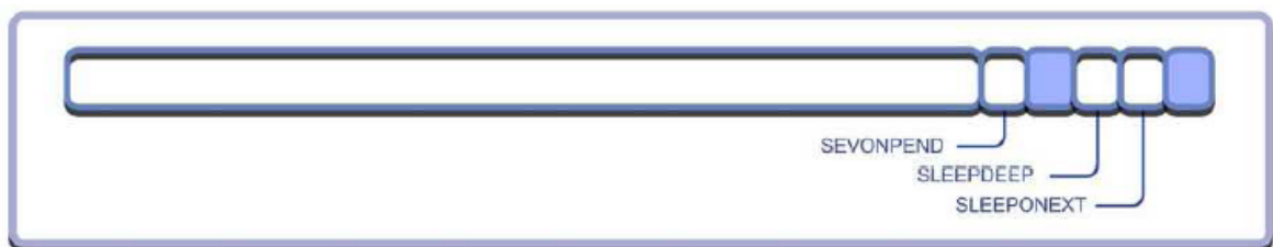
Hình 1.25. Thanh ghi điều khiển hệ thống dùng để cấu hình các chế độ ngủ của vi xử lý Cortex
