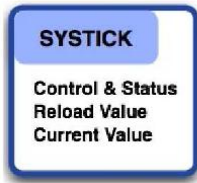
Hình 1.13. Các thanh ghi trạng thái và điều khiển của SysTick
