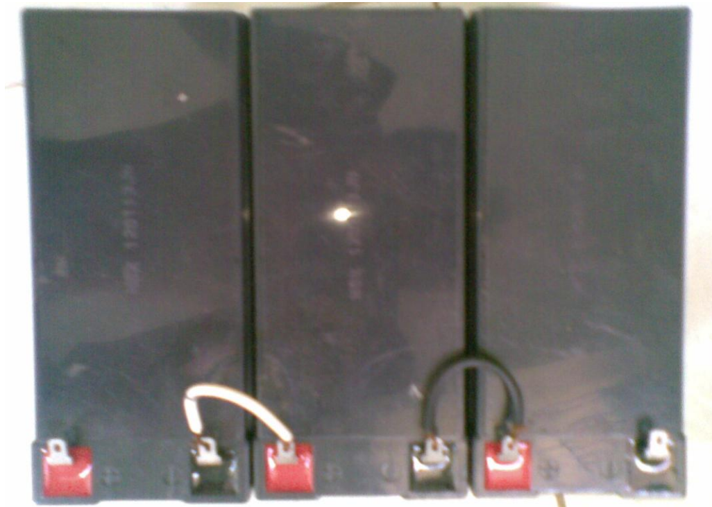
Hình 2.14. 3 Acquy mắc nối tiếp
