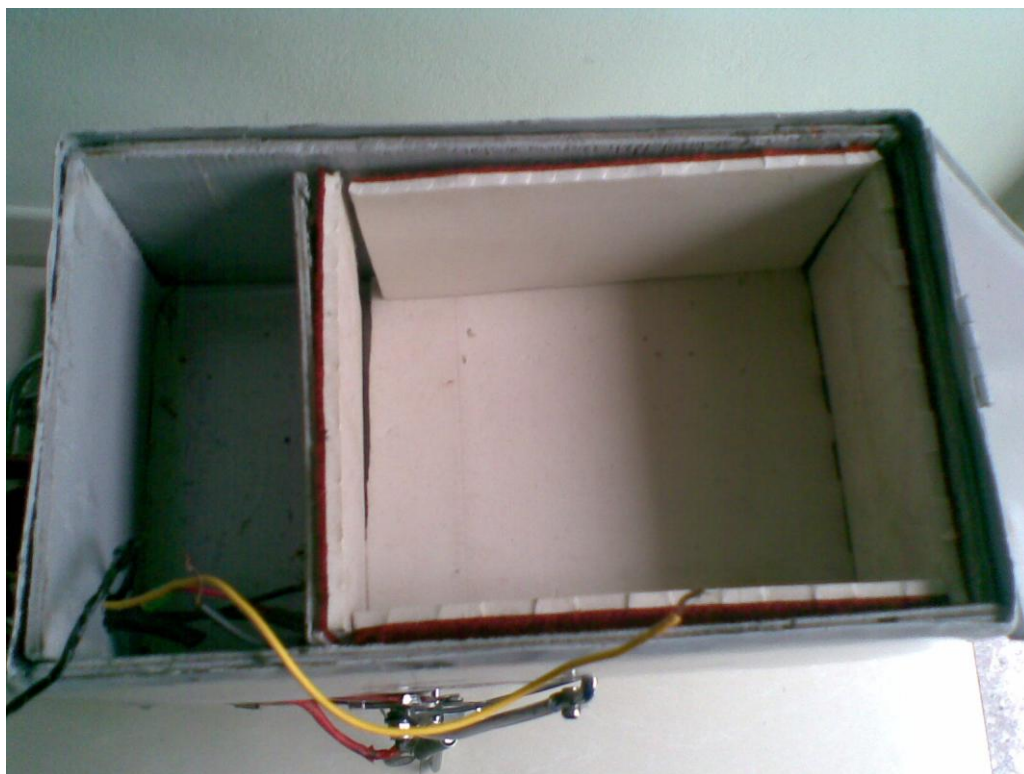
Hình 2.12. Lót gỗ và mút trong hộp điện
