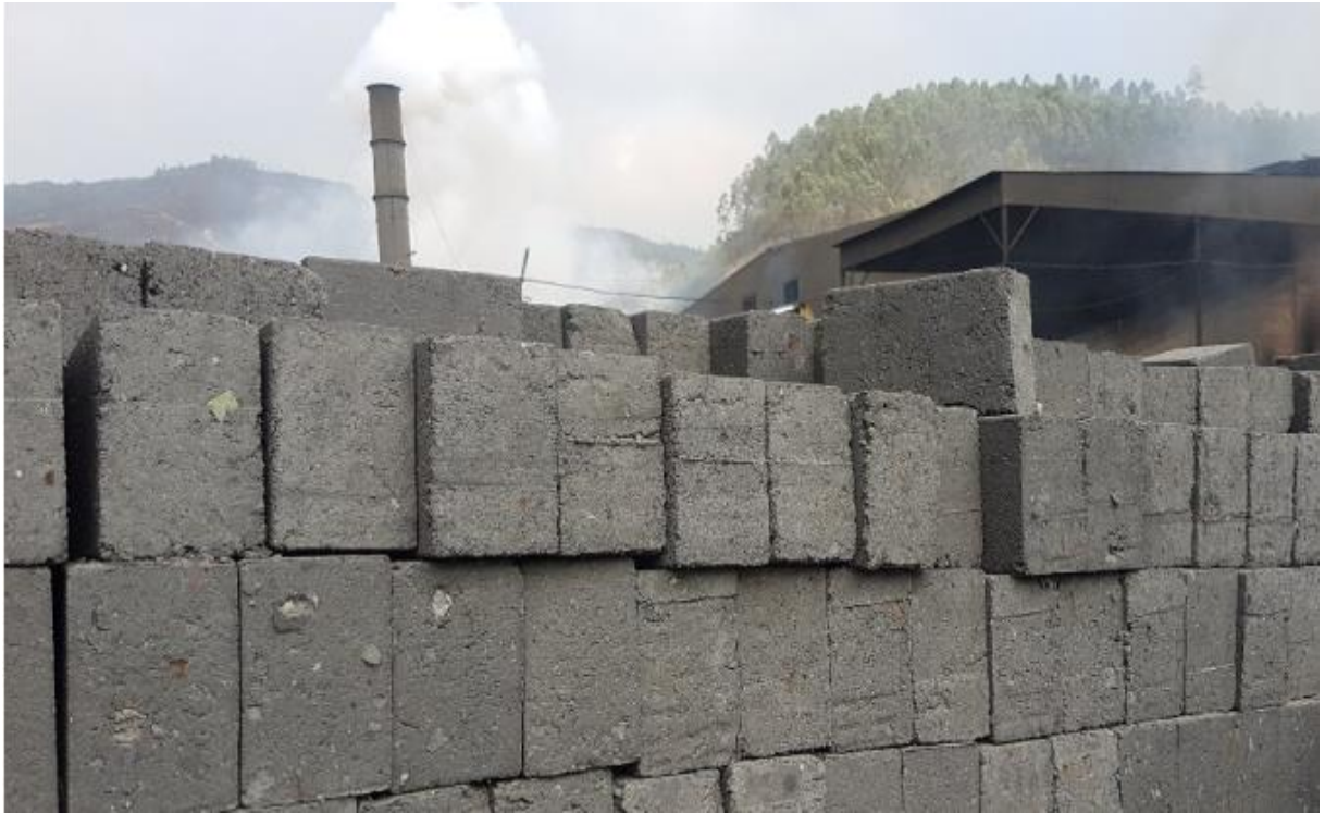
Hình ảnh 9: Nhà máy rác Khe Giang tận dụng tro xỉ từ lò đốt rác sản xuất gạch không nung.
