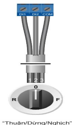
Hình 2.2.9.2: Chân đấu nối công tắc 3 vị trí
