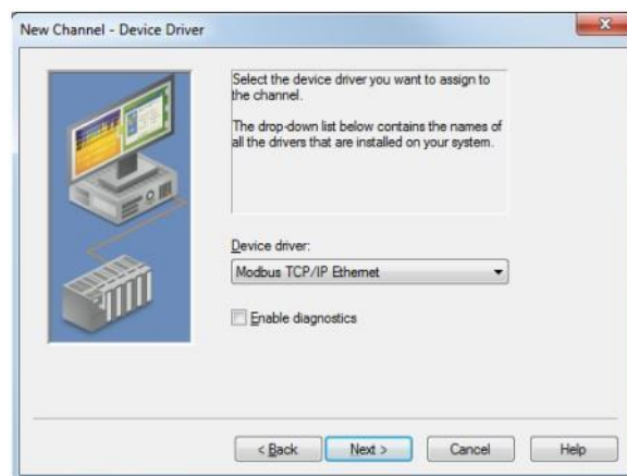
Hình 2.16 – Tạo kênh kết nối Modbus TCP/IP
