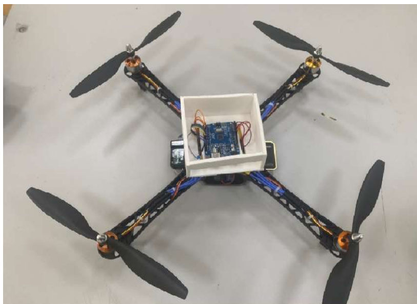
Hình 3.2: Lắp ráp khung Drone
