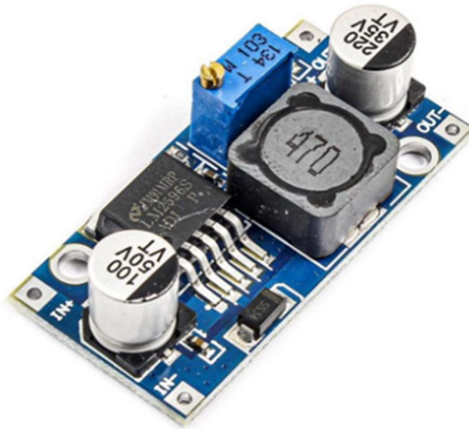
Hình 2.15: Mạch giảm áp LM2596
