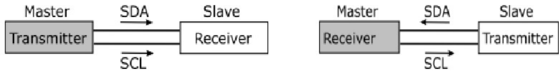
Hình 1.15. Truyền dữ liệu theo chuẩn I2C.
