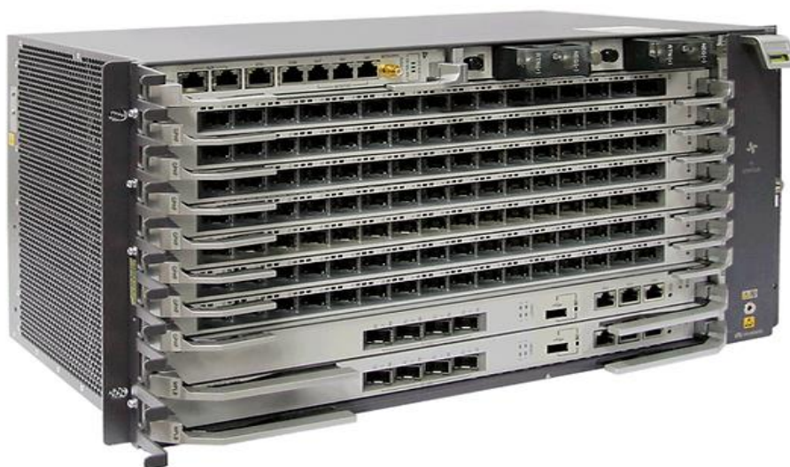
Hình 3.1: Cấu trúc thiết bị OLT Huawei MA 5800
