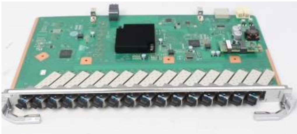
Hình 3.3: Mô tả Card thuê bao thiết bị Huawei MA 5800
