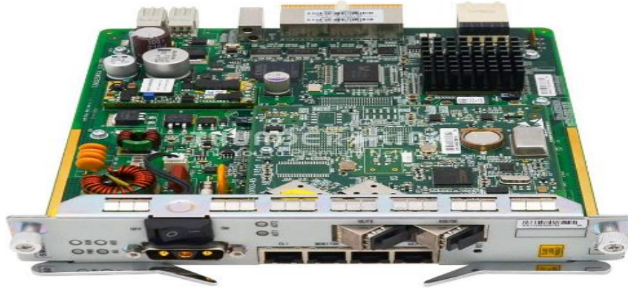
Hình 3.8: Mô tả Card xử lý SMXA thiết bị ZTE C320
