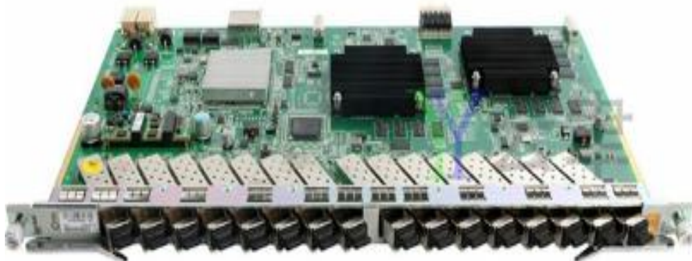
Hình 3.9 :Mô tả Card thuê bao GTGH thiết bị ZTE C320
