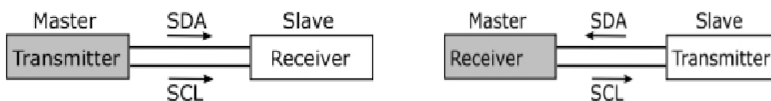
Hình 1.16. Truyền dữ liệu theo chuẩn I2C.
