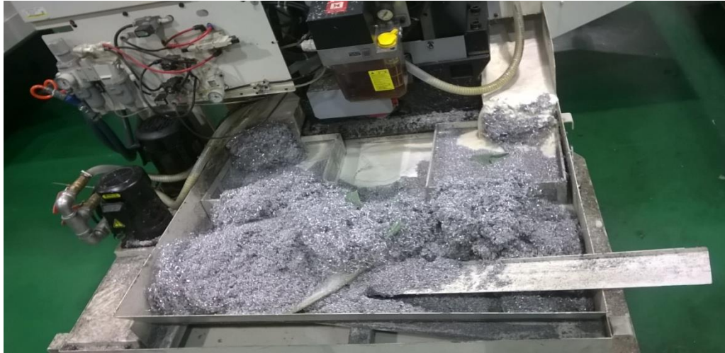
Hình 1.4. Phoi thừa phát sinh đi cùng dầu thải ra ngoài môi trường
